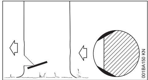
Splintschnitte verhindern bei langfasrigen Hölzern das Aufreißen des Splintholzes beim Fallen des Stammes – an beiden Seiten des Stammes auf Höhe der Fallkerbsohle etwa 1/10 des Stammdurchmessers – bei dickeren Stämmen höchstens bis Breite der Führungsschiene – einsägen.
